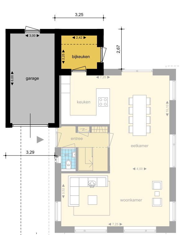
type 1 - inwendig 3,00 x 6,00 meter
