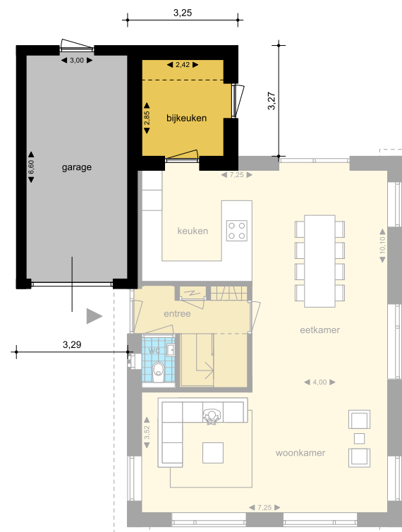
type 2 - inwendig 3,00 x 6,60 meter
