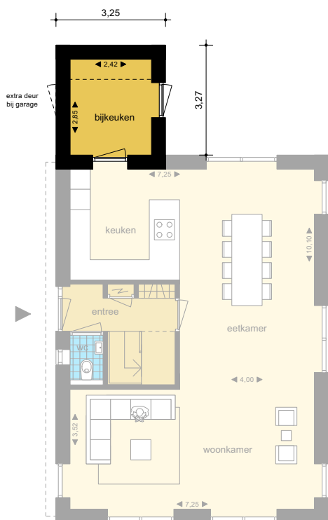
type 2 - inwendig 2,42 x 2,85 meter
